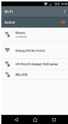
Dans les réglages Wi-Fi, sélectionner le réseau de la borne : ce réseau portera le nom de « **EVduty-EVC30-XXXXX** » où les X correspondent au numéro de série de la borne.
